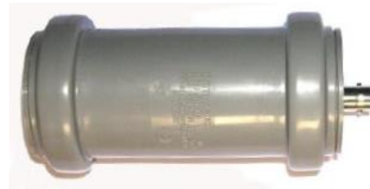
M-Whip wetterfest eingebaut in eine HT-Rohr Muffe
