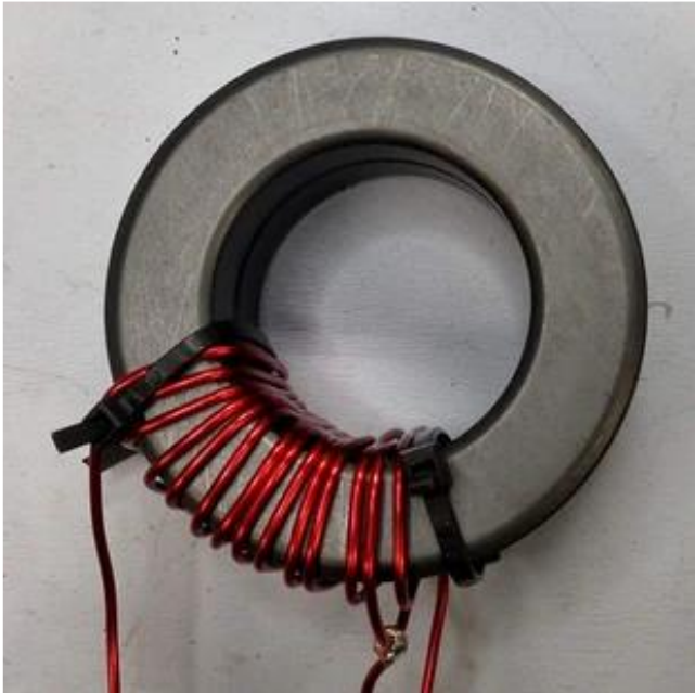
Durchgehende Wicklung als Autotrafo mit Anzapfung
