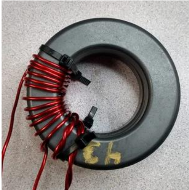
Wicklung bifilar verdreht, eng gewickelt - bester Koppelfaktor k
