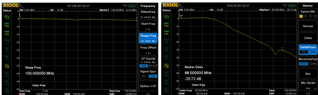
Bild 12 Übertragungsverhalten der Mega-Whip; „Flat“ (links) und mit zugeschaltetem UKW-Tiefpass (rechts)
