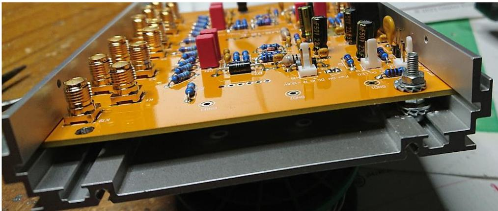
Bild links: Befestigung der Platine im Einschub-Profil mit Mutter M3
