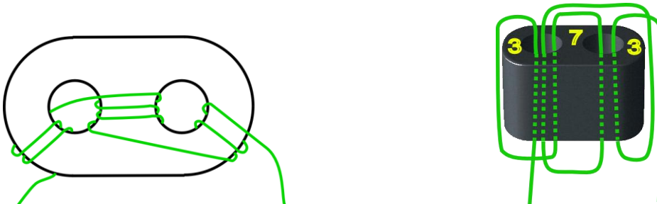
Bild 3 - Wickelschema L4 Breitband Drossel 1mH
