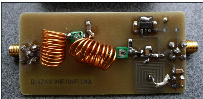
**Bild 1:** Prototyp des Vorverstärkers auf einer doppelseitig kupferkaschierten Leiterplatte; die SMA-Buchsen sind auf der Unterseite bestückt. Fotos: DL4ZAO
