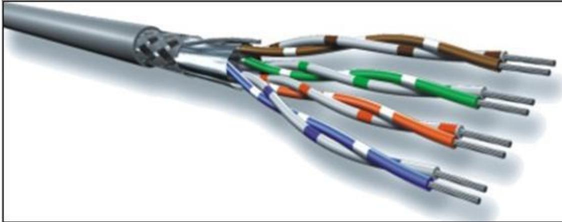
Ethernet Kabel aus der Netzwerktechnik besteht aus mehreren verdrillten symmetrischen Zweidrahtleitungen. Ein Aderpaar hat etwa  $100\Omega$  Wellenwiderstand. Je nach Aufbau des Kabels können darüber Signale kleiner Leistung bis mehrere 100 MHz übertragen werden.
