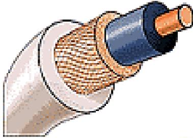
Wegen des Skin-Effekts wirkt die Schirm Außenschicht für Hochfrequenz wie eine separate Eindraht-Leitung. Sie hat einen unterschiedlichen (geringeren) Verkürzungsfaktor als die koaxiale Leitung im Inneren.
