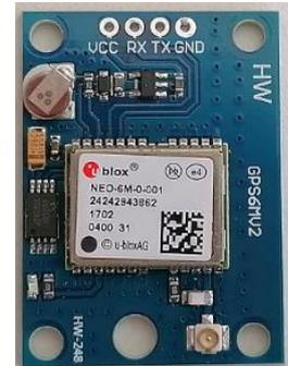
Da die meisten dieser Module keinen separat herausgeführten Ausgang für das TiP Rechtecksignal haben, wird der TiP mit einem angelöteten Drähtchen zwischen dem u-blox Modul und dem Vorwiderstand der LED abgenommen.
