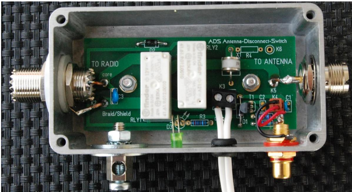
Bitte beachten: Die PL259 Durchgangsbuchse zum TRX „To Radio“ und die „Remote Off“ RCA-Buchse müssen vom Gehäuse sorgfältig isoliert eingebaut werden. Hierzu ist ein spezielles Isolierscheiben-Set vorgesehen. Der Widerstand R4 (1MΩ/1KV) ist optional und kann bei Bedarf zur Ableitung von statischen Ladungen eingesetzt werden.
