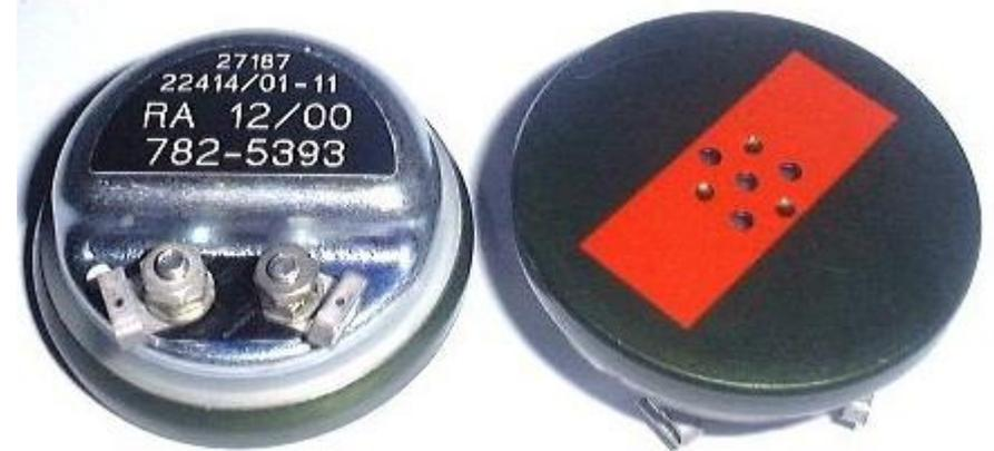
Detektorfreunde schwören auf die Verwendung der sogenannten soundpowered Kopfhörer. Sie zeichnen sich durch hohe Wiedergabelautstärke bei kleinen Eingangssignalen aus. Die Kapseln können über zwei Drähte einfach miteinander verbunden werden, und gestatten so ohne Batterie oder Verstärker eine gute Verständigung. Die Hörkapsel dient auch als Mikrofon. (Daher der Name „Sound Powered“).. [>>> Mehr dazu](#)
