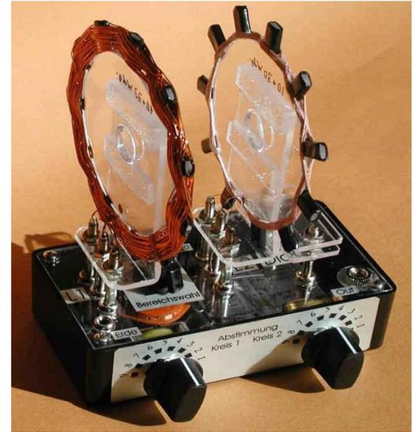
Ein hübscher kleiner Zweikreiser von Franz Gysi, der Experimente mit verschiedenen Spulen, Dioden und Detektoren zulässt.
