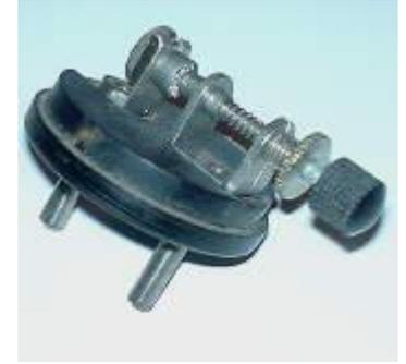
Germanium Spitzendioden werden nur noch vereinzelt hergestellt. Sie haben eine niedrige Schwellenspannung unterliegen aber auch großen Fertigungstoleranzen (Leckströme). Sie wurden von low barrier Schottky-Dioden abgelöst. Diese haben zwar eine etwas höhere Schwellenspannung, ansonsten aber viele Vorteile. (z.B. hoher dynamischer Widerstand, niedrige Leckströme)
