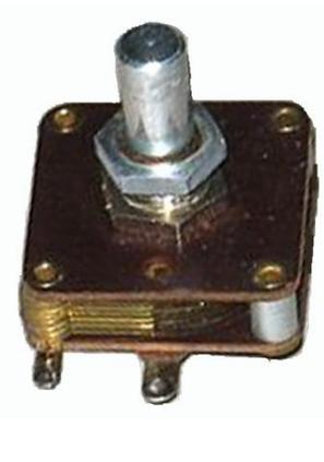
Der Drehko beeinflusst auch die Schwingkreisgüte. Der Stator soll Keramikisolatoren haben. Immer den Rotorkontakt mit dem kalten Ende „Masse“ verbinden, damit entfällt die „Handempfindlichkeit“
